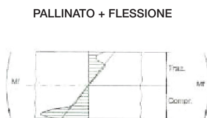
Fig.21 Pezzo pallinato e sottoposto a flessione
